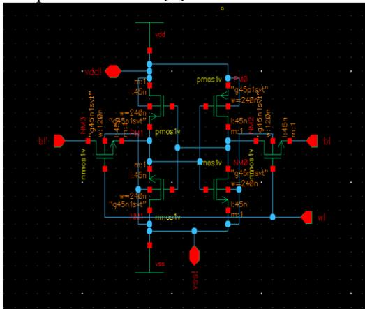
**Figure 2:** SRAM 6T Cell
